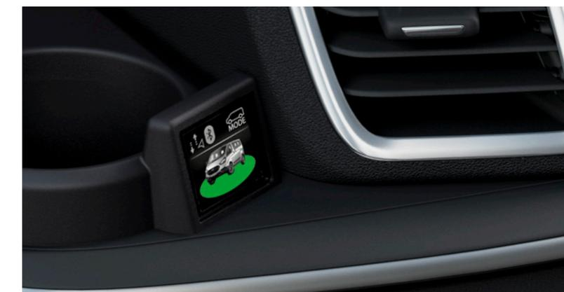
For at hjælpe med at forbedre luftkvaliteten i byområder, kommer Transit Custom Plug-In Hybrid nu med geofencing-teknologi. Systemet bruger live lokationsdata til automatisk at skifte til elektrisk køretilstand, når den kører ind i foruddefinerede områder, såsom lavemissionszoner<sup>†</sup>.
